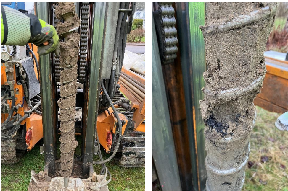
Figur 7. Påträffade fyllnadsmaterial i punkt CW01 (vänster; 0-0,5 meter under markytan) och i punkt CW05 (höger; 0-0,6 meter under markytan med inslag av asfalt).
